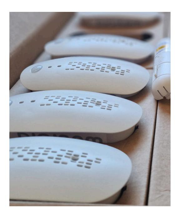
Equipamiento de sensórica implementado para monitorear las condiciones del entorno, detectando cambios relevantes en el comportamiento de las personas. Miden la luminosidad y humedad, sueño, alimentación, aseo, además de detectar en movimiento en las distintas estancias del domicilio.
